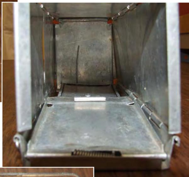
De plus, afin de bien prendre soin des pièges et de bien les nettoyer, les démonter s'avère plus pratique. Il suffit de tirer sur le crochet situé sur l'un des côtés de la partie inférieure du piège (ci-dessous).
